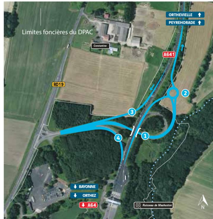
**La solution n°2**, quant à elle, conduit à supprimer le passage sous l'A641 et s'appuie sur la création de deux giratoires à l'Ouest de l'A641 :
